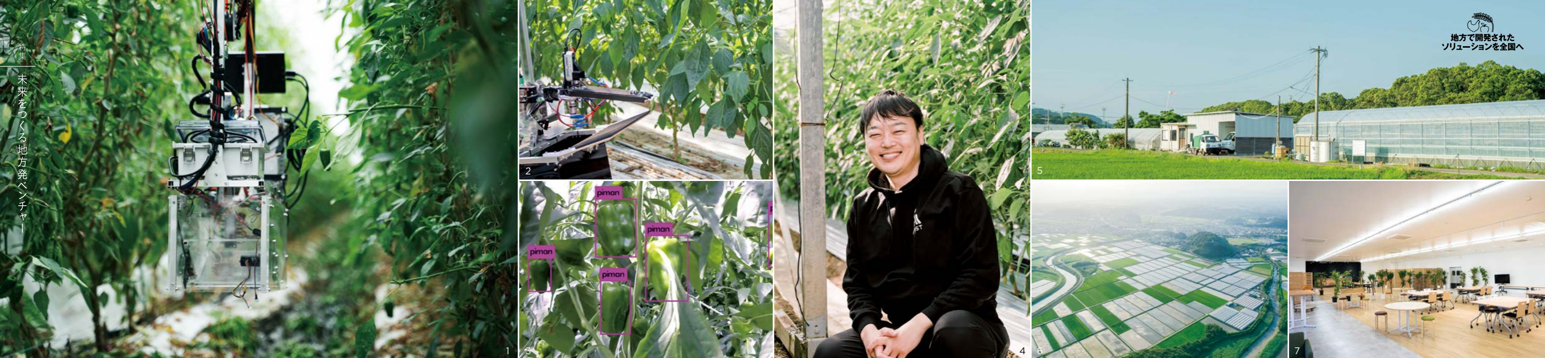
1_ビニールハウス内を移動する吊り下げ式自動収穫ロボット。PCT国際特許も出願中。2_巻き込み型のアームを使ってピーマンなどの茎を切断し、収穫する。3_ロボットのカメラで農産物のサイズなどを認識。画像提供/AGRIST
