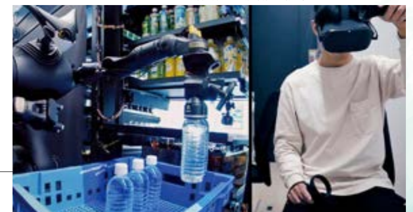
コンビニエンスストアのバックヤードでペットボトル飲料の陳列を遠隔操作する様子。
