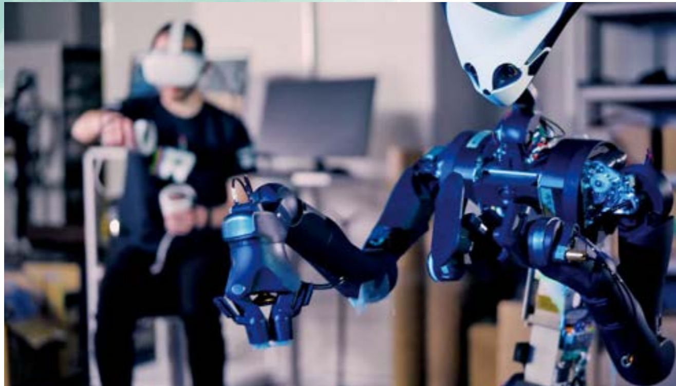
Telexistence社が開発した遠隔操作ロボット「Model-T」。商品陳列業務用に最適化されており、インターネット環境さえあればロボットを通じて遠隔から労働参加できる世界を目指している。
