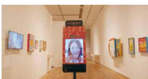
複数人(※現状最大5人)でログインし、ビデオチャットをしながらロボットを操作することでイベントを楽しんだり、ロボットのスピーカーを通じて遠隔地にいる人のコミュニケーションをとることができる「ROBOT VIEWING」。
