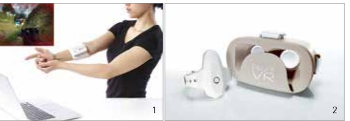
1 「UnlimitedHand」は腕に巻くだけで、簡単に装着可能。触感を再現するだけでなく直感的なゲーム操作ができる。2 VR初心者でも気軽に使用できる「FirstVR」。センサーで手指の動きを読み取って、VR空間を手だけで自在に操作。VRゴーグルもセットになっている。
