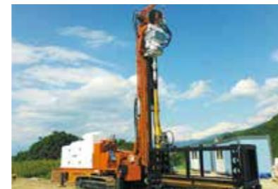
武藤博士が昨年取り組んだのが、AIを使った掘削自動制御。東亜利根ボーリングが製造するボーリングマシン(写真)専用のプログラムで、熟練技術者でなくとも円滑に掘削制御できる。
