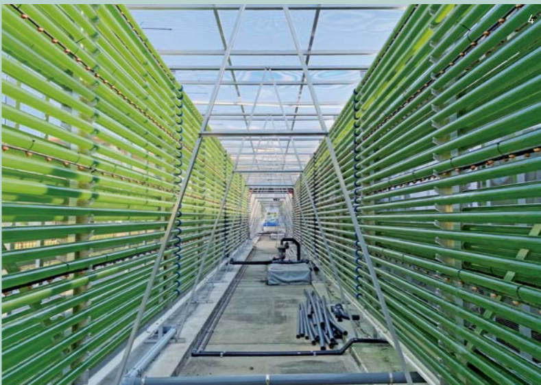
4_同社が保有する国内最大規模のガラスチューブ型フォトバイオリアクター。これによりこれまで培養困難とされてきた有用微細藻類の大量培養や商業利用が可能になった。2022年2月にはロート製薬と共同で藻類研究拠点「AMU LABORATORY」を設立。微細藻類の培養検討から製品応用などの研究を行っている。5_微細藻類の培養実験の様子。
