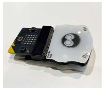
小学校のプログラミング教育で導入されているマイコンボード「micro:bit(マイクロビット)」に「ぶよびっと」を装着し、コントローラにする設計を施した。
