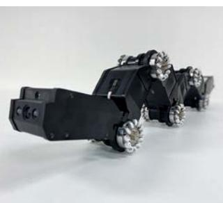
「配管くん」は、探査する配管のサイズに合わせて3タイプ4機種を揃える。直径25mmからの配管に対応可能だ。写真は、直径100~150mmの配管内を自走可能な「配管くんI型」。
