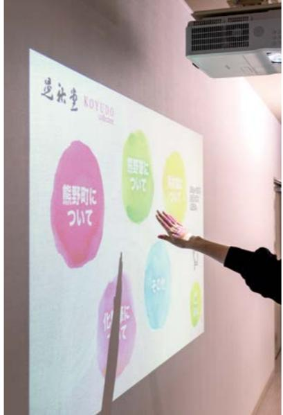
化粧筆工房内に設けられた、工場見学者向けの映像とゲームコンテンツ。天井に設けたセンサーで人の動きを感じ、タッチレスで映像メニューを選択できる。
