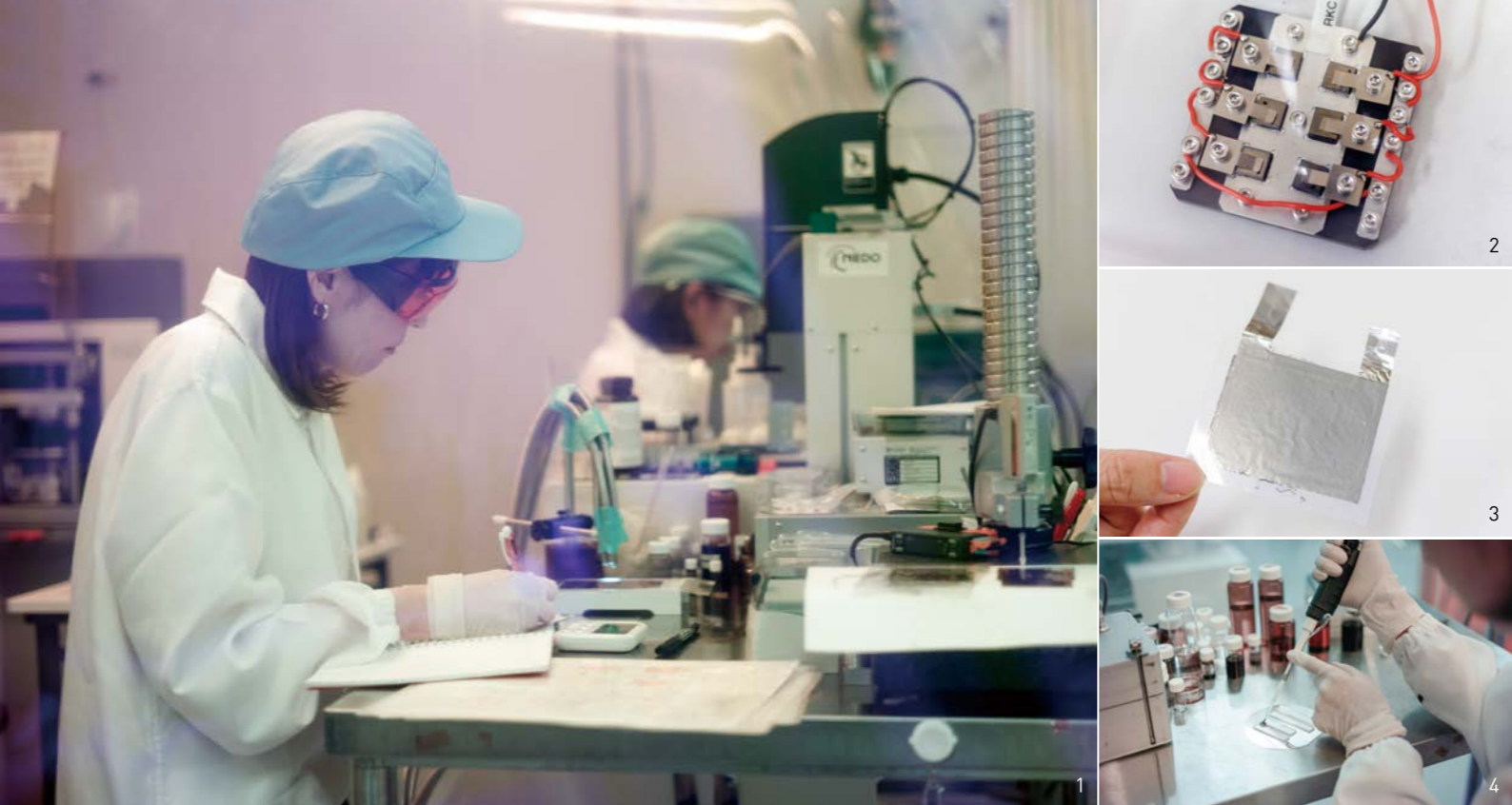
1_同社は、つくば研究支援センター内の創業プラザに研究室を持つ。クリーンルーム内に熱電素子の作製を行っている様子。2_積層化した発電素子を6つつないだデバイス。これにドライヤーの熱を当てて出力テストを実施。3_薄い金属シートタイプのデバイス。大面積化に向けて開発を進めている。4_金属ナノ粒子入りの溶液を電極に塗布している様子。この金属ナノ粒子が同社の強みだ。熱電材料以外にも医療分野など幅広い応用が見込めることから、2023年5月に会社分割し、金属ナノ粒子の製造技術開発事業を株式会社illuminusが事業継承した。
