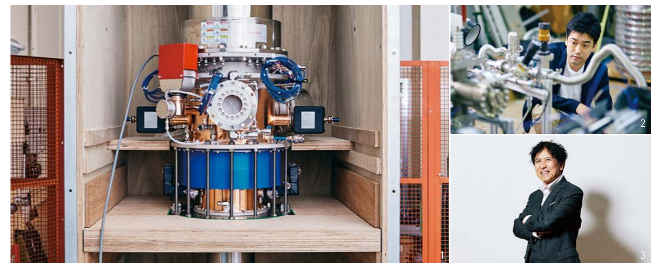
1_核融合炉においてプラズマ状態を作り出すために必要な加熱システムの「ジャイロトロンシステム」。英国原子力公社や海外のスタートアップ企業からの受注実績もある。2_核融合エネルギーの実現に向け、研究開発に励む社員。3_共同創業者でCEOの小西哲之さん。40年にわたり、核融合工学、核融合炉設計、「ITER」プロジェクトなどに携わる。東京大学博士(工学)。
