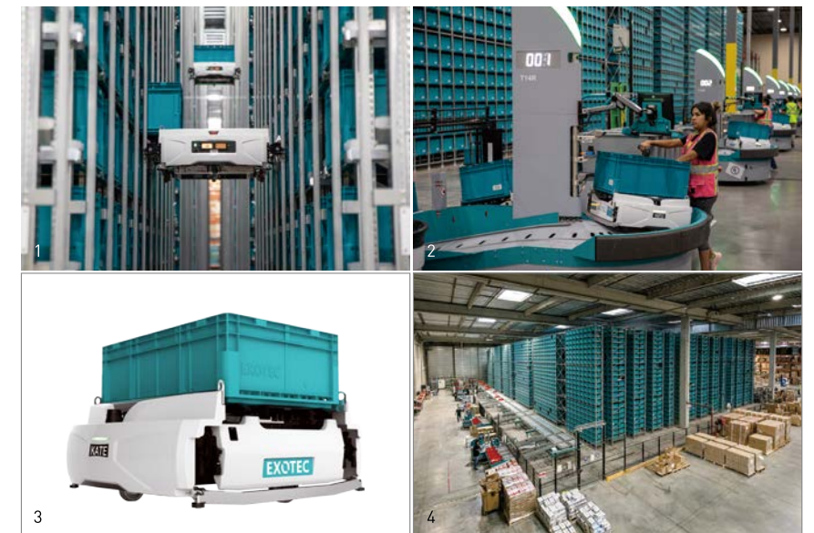
1.独自のクライミングシステムにより最高12mの高さまで昇降可能。2.ロボットがラックから搬送してきた商材を、ステーションにいる人間がピッキングする。3.高性能バッテリーを搭載しており、5分の充電で1時間稼働が可能。低温下(0°C)でも稼働できるので、冷蔵倉庫でも対応可能だ。4.保管ラックエリアは人間が立ち入ることはできず、ロボットのみが自走する。
