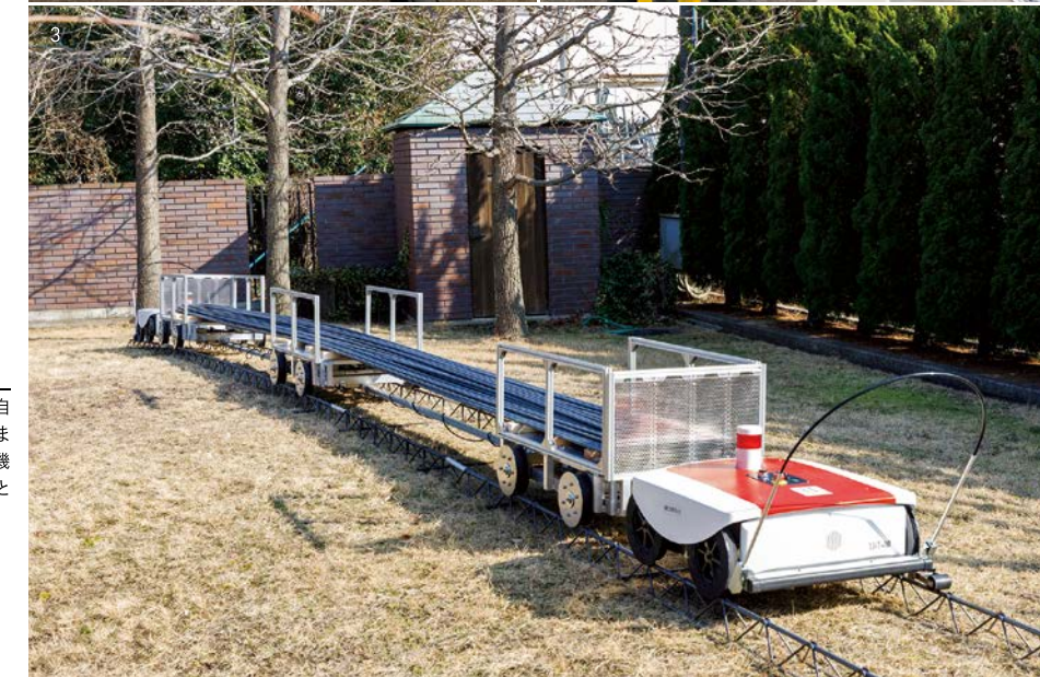
1_2_アメリカでの展示会における鉄筋結束トモロボの展示風景。3_今年より提供を本格化する運搬トモロボ。敷設されたレール上を自走して鉄筋などの重量物を運ぶ。本体は軽自動車のトランクに収まるサイズ、大人1人で運べる重量を実現。ベース台車にオプション機材を装着してさまざまな積荷に対応し、最大500kgを運搬することができる。用途や資材に応じた台車を別途開発することも可能。
