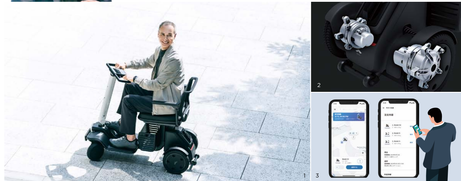
1_前輪がほぼ直角に曲がり、その場での旋回が可能なWHILL Model R。国内最小クラスの小さい回りで、狭い場所でも安心かつスマートに走行できる。2_後輪の回転数を独立して制御することで、高い小回り性能や走行安定性を実現するデュアルモーターシステム。世界的な総合モーターメーカー、ニデックと共同開発した。3_アプリ上の地図から外出先の施設を検索し、機体を予約できる「WHILLレンタル」。
