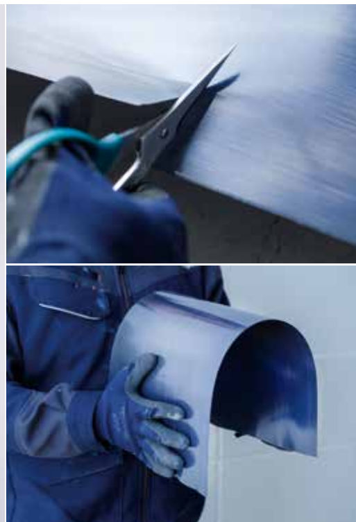
CFRTPシートの表面に独自のプラズマ処理を施し、高い接着性を実現したAPLASシート。はさみやカッターで切ることができるので、現場で寸法の調整も可能。
