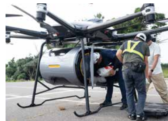
「EH216L」の試験飛行では、160kgもの重りを搭載したフライトも成功。
