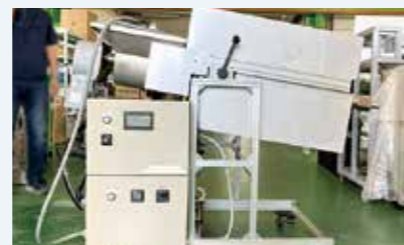
従来より低い温度で炭化できる現場設置可能な小型装置。
