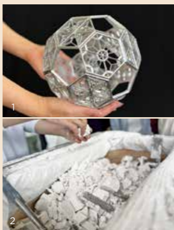
1_モールドモデルが石膏鋳造により手がけた製品。同社はデザイン性の高い製品も得意としている。 2_製造工程の中で大量に生じる廃石膏。従来は埋め立てによって処理するしかなかった。
