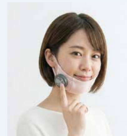
umaiNaは、頬周辺に装着する独自のデバイス。微弱な電気刺激により味覚をやさしくサポートし、食事の“風味”をより豊かに感じさせる。充電式で気軽に持ち運べるので、日常のさまざまな食事シーンで利用できる。個人差や日々の体調によって変化する味覚に対応した刺激レベルの調整も可能だ。
